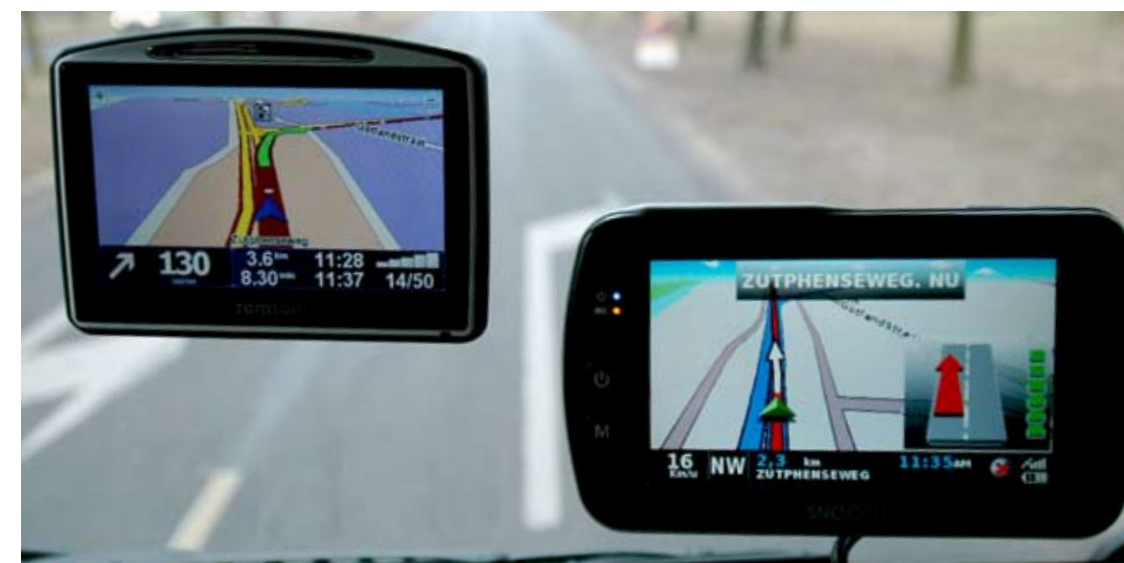
Verskil van mening: TomTom (links) wil afslaan, Truckmate rechtdoor. Het rode kruis rechtsonder geeft aan dat er geen truckdekking is.
